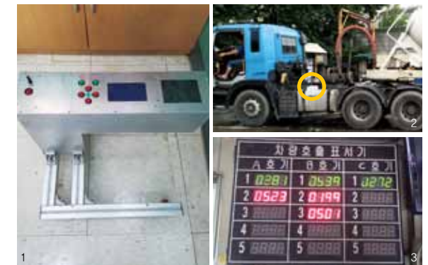
1. 이동식 슬럼프 및 플로우 테스트 장치 2. 주유구 개폐확인장치가 탑재된 BCT 차량 3. 균등배차관리 시스템이 적용된 차량 호출 표시기
